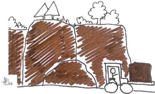
Im Steinbruch werden große Blöcke aus z.B. Sandstein gebrochen, meist durch Sprengung. Diese werden maschinell ins Sägewerk transportiert.
