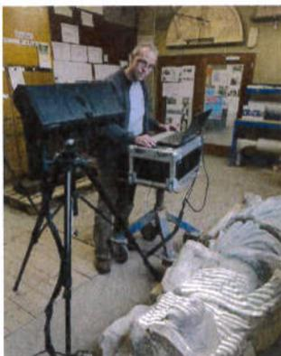
Mittels eines 3D-Laser-Scanners können wir zudem Objekte digitalisieren. Die Säge fertigt dann anhand der Daten originalgetreue Kopien, die von unseren Steinmetzen endbearbeitet werden (Foto: Initiative Neue Qualität der Arbeit (IMQA) für Natursteine Glöckner, 2015)
